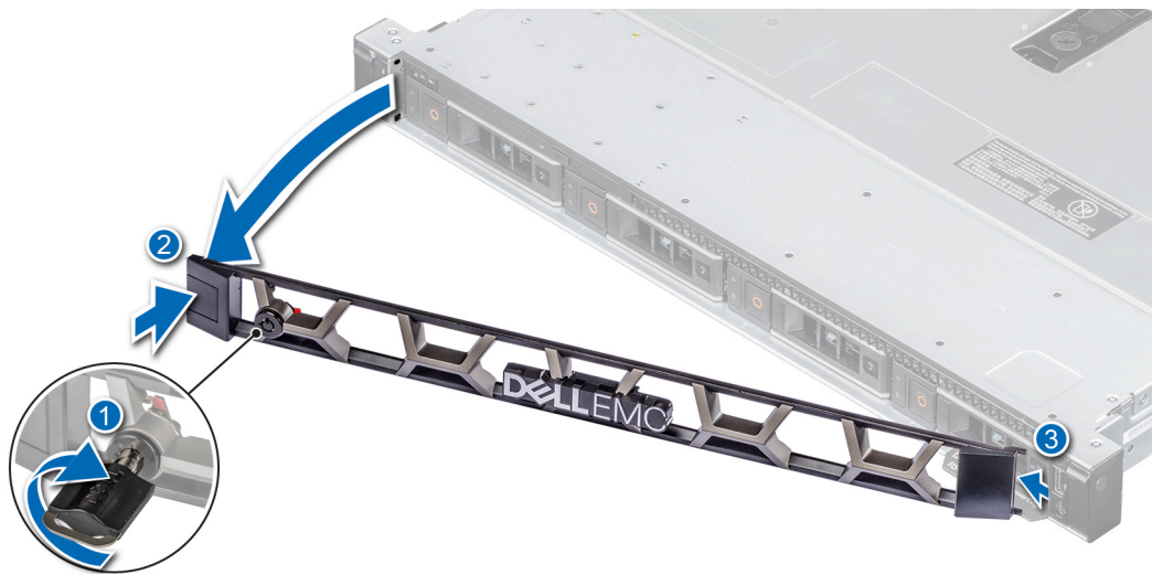
Figura 13. Extracción del bisel frontal opcional
