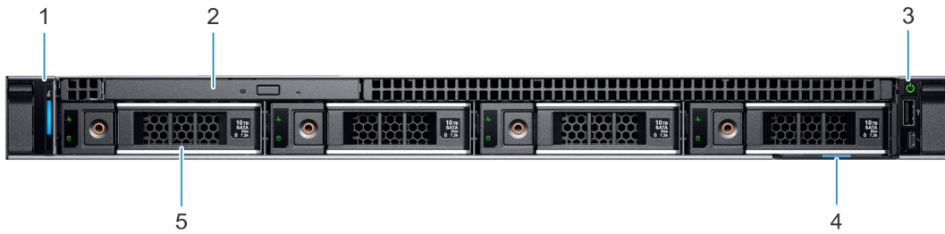
Figura 2. Vista frontal del sistema de unidad de 4 x 3.5 pulgadas
