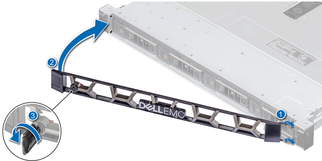
Figura 14. Instalación del bisel frontal opcional
