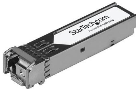
El modelo 10057-ST es un transceptor SFP Upstream por Fibra Óptica compatible con MSA, que se puede emparejar con 10056H-ST de StarTech.com. Ha sido diseñado, programado y probado para su funcionamiento con routers y switches MSA compatibles con 1000Base-BX. El módulo transceptor SFP+ admite una distancia máxima de hasta 10 km y conectividad confiable a 1 GbE a través de cableado de Fibra Óptica.
