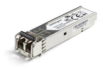
El modelo SFP1GBX10DES es un transceptor SFP Downstream por Fibra Óptica compatible con MSA, que se puede emparejar con SFP1GBX10UES de StarTech.com. Ha sido diseñado, programado y probado para su funcionamiento con routers y switches MSA compatibles con 1000Base-BX10. El módulo transceptor SFP+ admite una distancia máxima de hasta 10 km y conectividad confiable a 1 GbE a través de cableado de Fibra Óptica.
