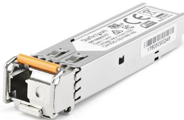
El modelo SFP1GBX40UES es un transceptor SFP upstream por fibra óptica compatible con el modelo SFP-1G-BX40-U de Dell EMC, que se puede emparejar con SFP1GBX40DES de StarTech.com. Ha sido diseñado, programado y probado para su funcionamiento con routers y switches MSA compatibles con 1000Base-BX40. El módulo transceptor SFP+ admite una distancia máxima de hasta 40 km y conectividad confiable a 1 GbE a través de cableado de fibra óptica.
