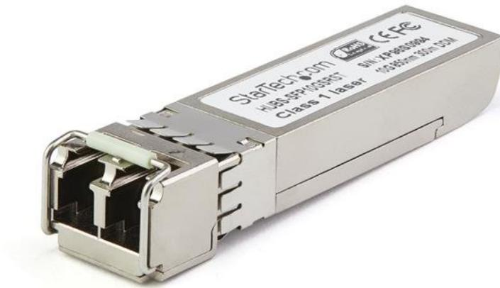
El modelo SFP10GUSREMS es un módulo transceptor SFP+ por fibra óptica compatible con el modelo SFP-10G-USR de Dell EMC diseñado, programado y probado para su funcionamiento con routers y switches de la marca Dell EMC™. Ofrece conectividad confiable a 10 GbE, a través de cable de fibra óptica, para redes compatibles con 10GBase-SR, a una distancia máxima de hasta 150 m.
