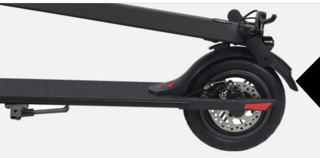
**¡Frena!** En algún momento tendrás que bajar la velocidad, el Kick Scooter cuenta con freno electromagnético en la rueda delantera y freno de disco en la parte trasera
