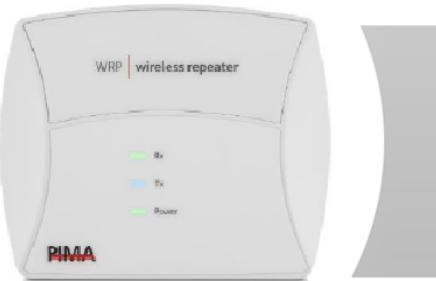
El WRP es un repetidor inalámbrico diseñado para ampliar el alcance y la calidad de la señal de los detectores y periféricos inalámbricos de PIMA. El WRP puede usarse para ayudar con los problemas de transmisión causados por ruido excesivo u otras interferencias, o por largas distancias entre los periféricos y el panel de control.
