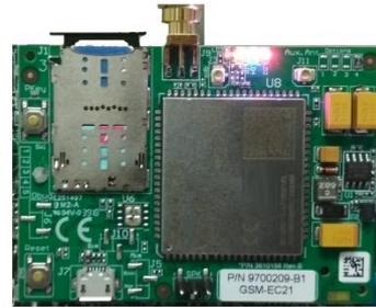
El CLM422 es un módulo accesorio celular LTE, categoría 1 que permite a los sistemas de alarma<sup>1</sup> de la **serie FORCE** comunicarse a través de la red celular. Este accesorio modular se instala en la placa de circuito del panel de control e incluye una antena.
