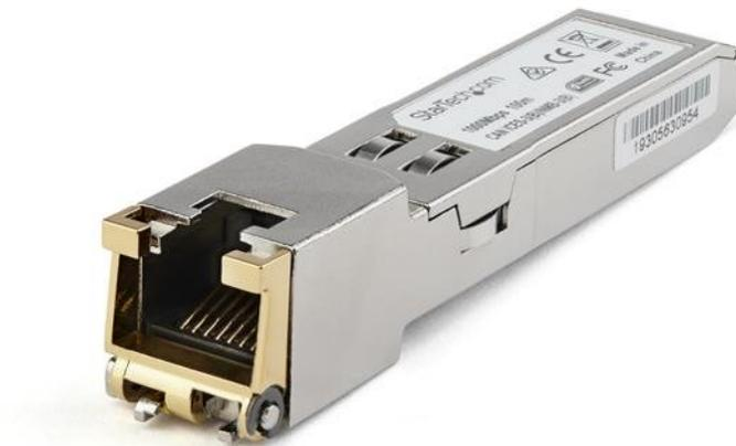
El modelo GLCTEST es un módulo transceptor por cobre compatible con el modelo GLC-TE de Cisco, diseñado, programado y probado para su funcionamiento con enrutadores y switches de la marca Cisco®. Ofrece conectividad 1GbE fiable a través de cable de cobre para redes compatibles con 1000BASE-T, con una distancia máxima de hasta 100m.
