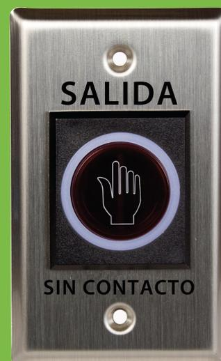
El botón de salida K1 ofrece el novedoso concepto “sin contacto” al incorporar un sensor óptico infrarrojo que permite realizar la solicitud de apertura de una puerta sin la necesidad de hacer contacto físico con el botón, tan solo con el movimiento de la mano por encima del sensor a una distancia de hasta 10cm.
