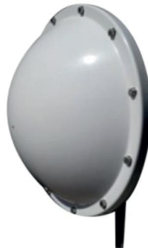
El uso de un radomo ayuda a disminuir la fuerza de impacto del viento sobre una antena de plato. Según la norma TIA-222, el uso de un radomo puede disminuir más del 30% del choque directo del viento sobre la antena, o como lo llama la norma: **Área Efectiva Proyectada**.
