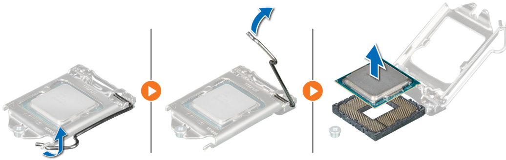
Figura 66. Extracción del procesador
