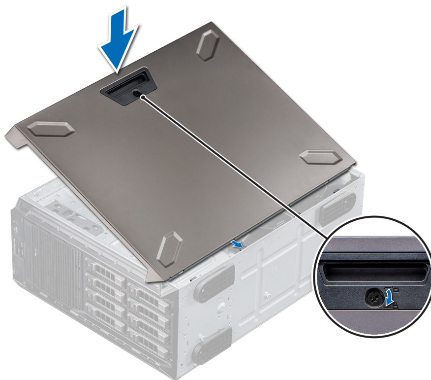
Figura 23. Instalación de la cubierta del sistema
