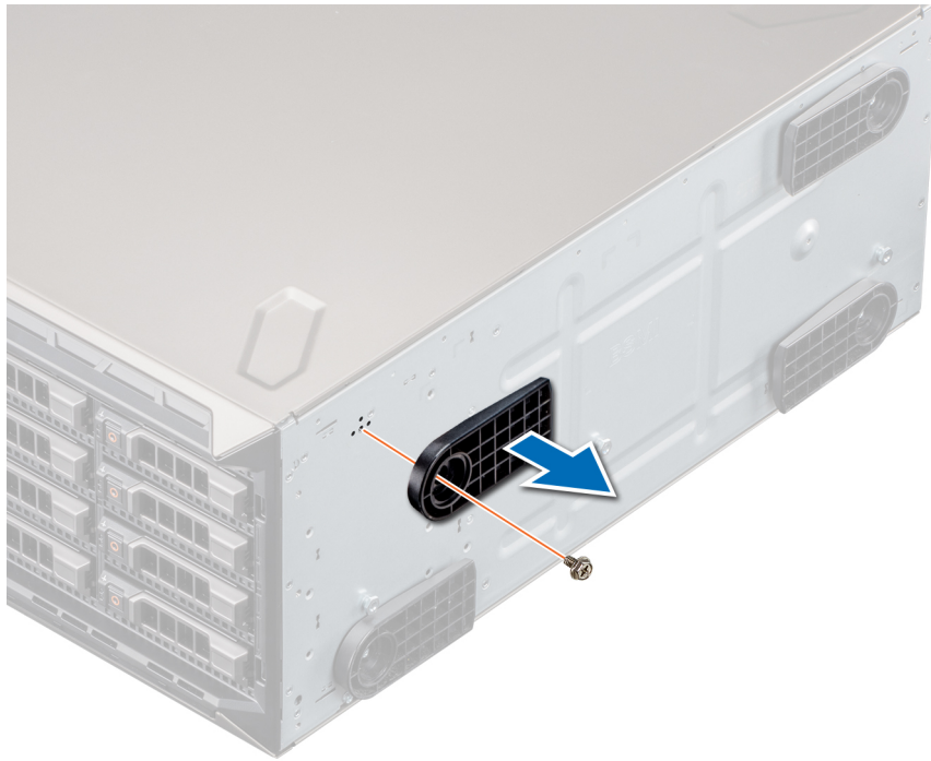
Figura 19. Extracción de los pies del sistema
