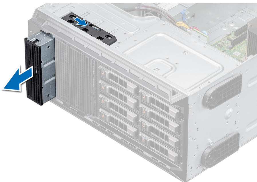
Figura 40. Extracción de la unidad óptica
