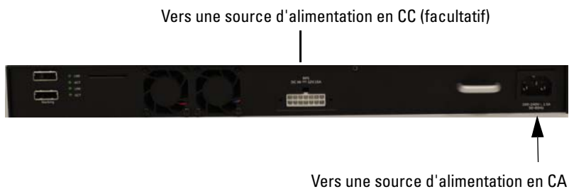
Figure 1-11. Connexion des câbles d'alimentation en CA et en CC à un commutateur N2048
