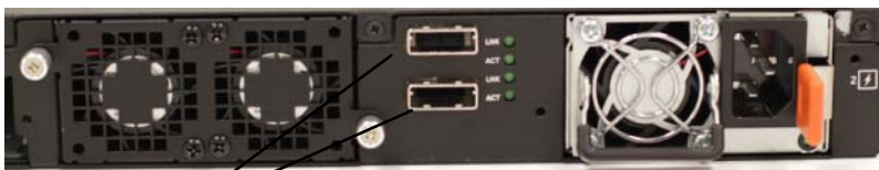
Ilustración 1-18. Ampliación de los puertos de apilamiento mini-SAS de N3048
