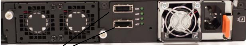
Şekil 1-18. N3048 Mini-SAS Yığın Bağlantı Noktaları Yakından Görünüm
