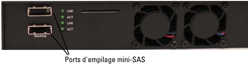
Figure 1-6. Ventilateurs et ports d'empilage mini-SAS N2048
