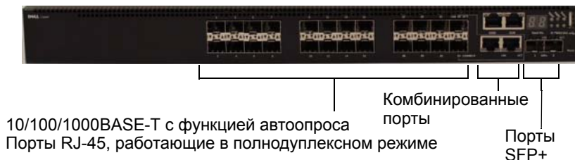
Рисунок 1-12. Серия N3024F с 24 портами 10/100/1000BASE-T (передняя панель)
