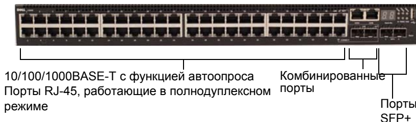
Рисунок 1-13. Серия N3048 с 48 портами 10/100/1000BASE-T (передняя панель)
