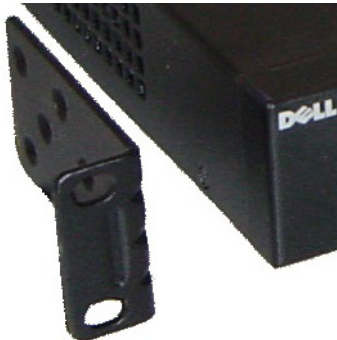
Abbildung 1-7. Befestigen der Montagehalter
