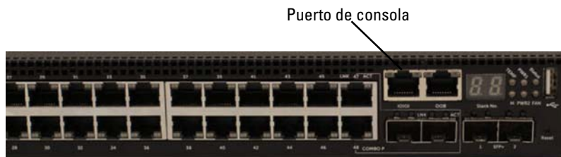
Ilustración 1-25. Ubicación del puerto de consola en el conmutador N3048
