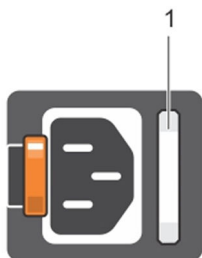
Figura 9. Indicador de estado de la unidad de fuente de alimentación de CA
