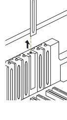
Entfernen Sie die Slotblenden, die den PCIe-Steckplätzen entsprechen, in denen Sie die GeForce®-Grafikkarte installieren (falls keine Grafikkarte vorhanden war).
