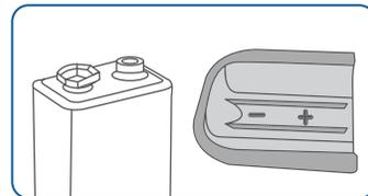
Inserta una batería de 9 V (recargable o alcalina)\*. Asegúrate de que la polaridad sea la correcta.
