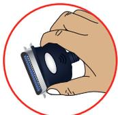
Para desconectar el equipo, jale del conector y retirelo del puerto. Nunca jale del cable.
