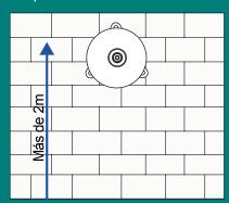
2. Tome como referencia la base de la campana para realizar las marcas de perforación. Realice las perforaciones e inserte los taquetes.
