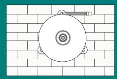
Tenga cuidado al realizar las perforaciones, de que no existan tuberías ocultas con cableado eléctrico, gas o agua.
