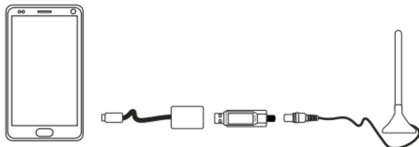
Conecta el sintonizador al puerto micro USB del cable OTG, y el conector micro USB a tu smartphone. *Si deseas ingresar a la aplicación automáticamente cada vez que conectes tu Smart Tuner; pulsa **OK**.*
