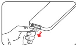
Para reemplazar la batería abre el compartimento. Coloca una nueva batería tipo botón CR2025. Asegúrate de que la polaridad de la batería esté en la posición correcta.
