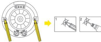
3. Coloca taquetes, y fija la base con tornillos. Al terminar, coloca la tapa y girala en el sentido de las manecillas del reloj.
