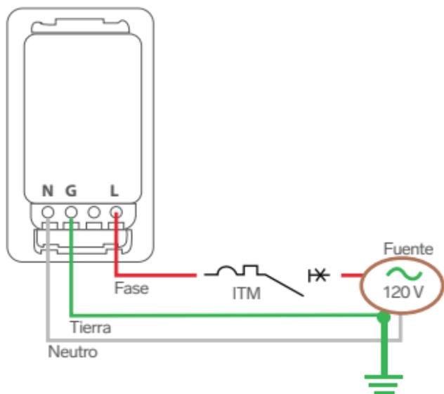
**2** Coloca el módulo de contactos en el registro eléctrico. Después, presiona la placa sobre éste.
