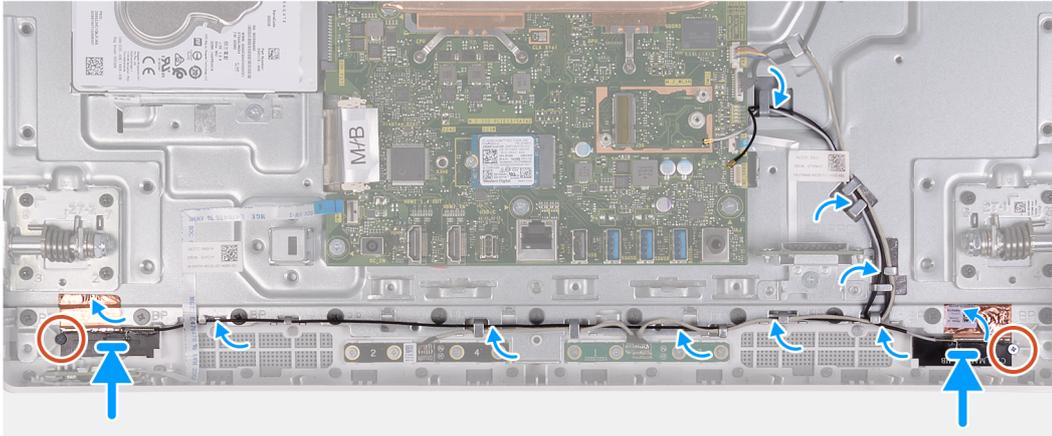
**NOTA:** Anote la ubicación de los módulos de la antena impresa en la base del ensamblaje de la pantalla como ANT-B (negra) y ANT-W (blanca).
