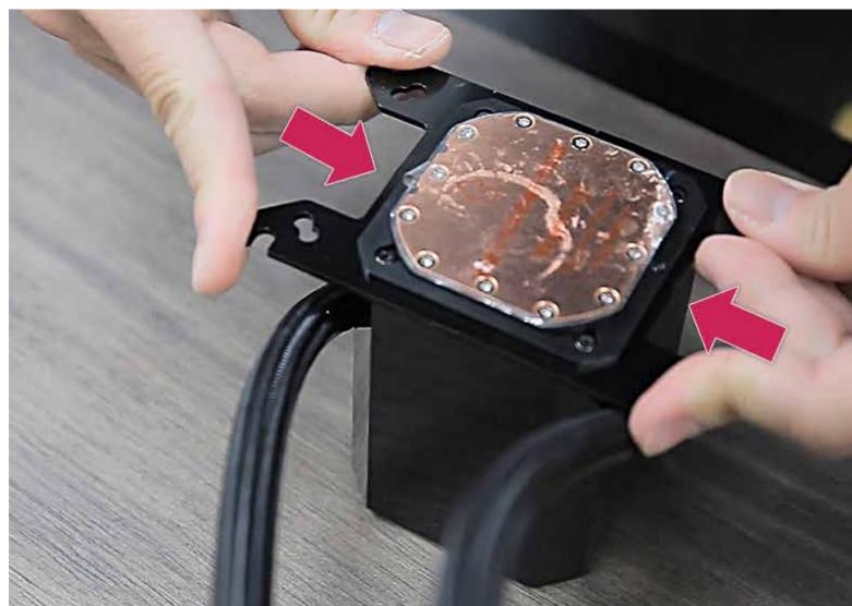
B. Aplique el compuesto térmico de manera uniforme en la superficie de la CPU.
