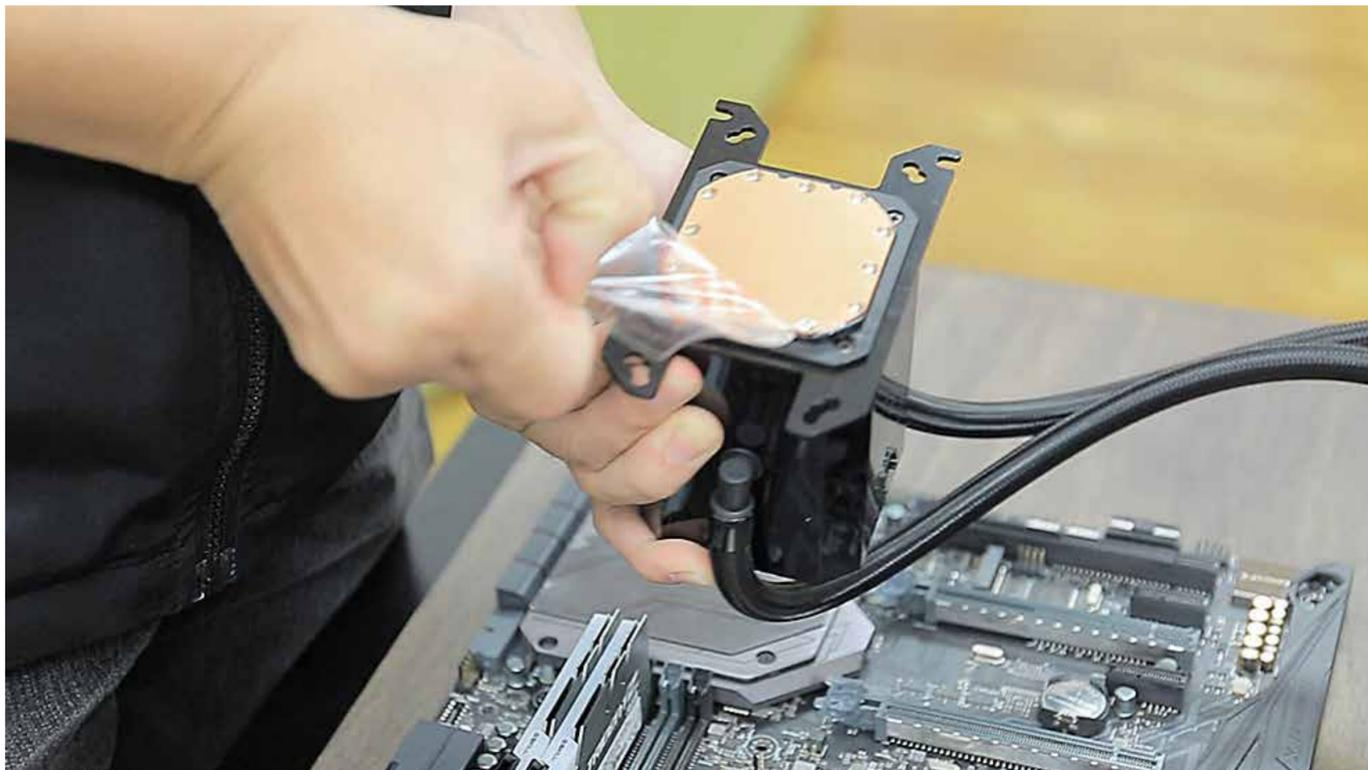
D. Instale la unidad de la bomba y luego apriétela con los tornillos de apriete manual.
