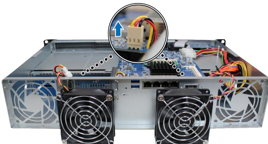
b Quite los tornillos que fijan la protección del ventilador del ventilador defectuoso.
