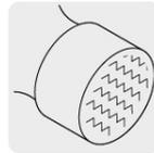
Cara fresada que permite un impacto sin deslizamiento
