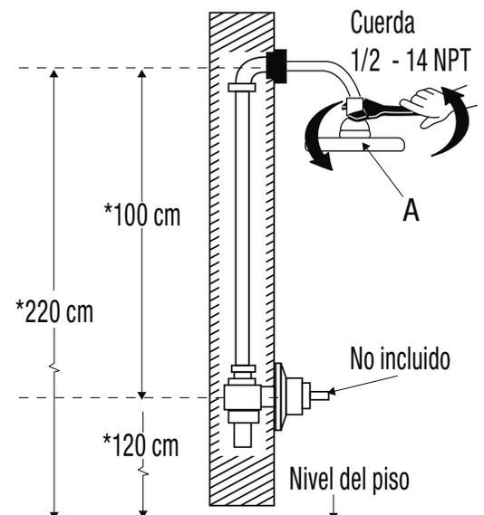
\*Medida recomendada. Coloque la regadera (A) Nota: En todas las uniones roscadas utilizar cinta teflón, para evitar fugas.
