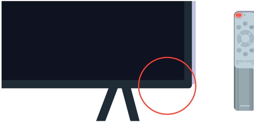
Si el sensor del control remoto se apaga cuando presiona el botón de encendido, su televisor está bien conectado a la fuente de alimentación.
