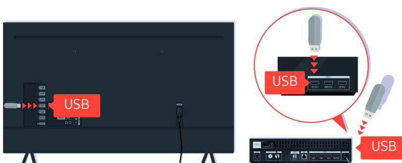
Inserte el dispositivo USB en la ranura USB en la parte posterior del televisor o en la parte lateral de la caja de One Connect.
