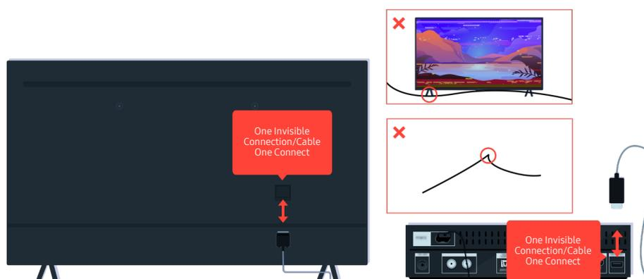
Si el problema persiste, y si su televisor utiliza One Invisible Connection o Cable One Connect, desconecte y vuelva a conectar One Invisible Connection o Cable One Connect al televisor y la caja de One Connect. Asegúrese de que One Invisible Connection o Cable One Connect no esté demasiado apretado o retorcido.
