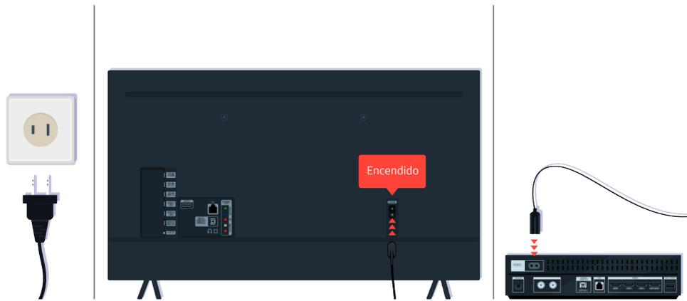
Si el sensor del control remoto no se enciende, desenchufe el cable de alimentación y vuélvalo a enchufar.
