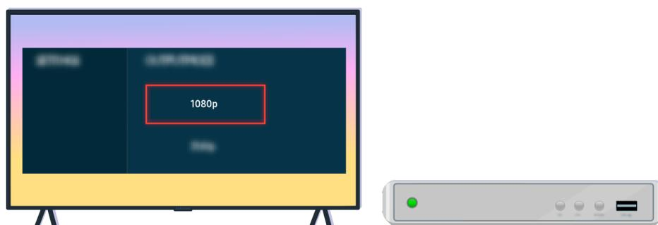
Si el problema persiste, verifique los ajustes de salida de video en el menú de ajustes del dispositivo externo, y asegúrese de que su televisor admita el modo de salida de video.
