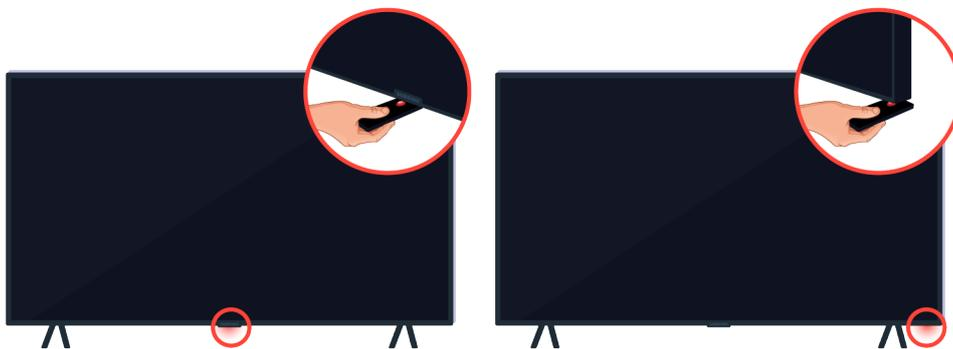
Puede encontrar fácilmente el sensor del control remoto sosteniendo un objeto reflectante como un espejo debajo del televisor.
