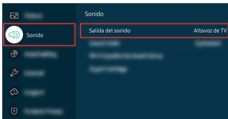
Verifique el volumen en la pantalla. Si no se muestra un número para el volumen del televisor, seleccione
