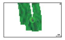
Un círculo verde indica una profundidad y posición GPS óptimas, y una velocidad inferior a 16 km/h (10 mph). Un círculo amarillo indica una profundidad y posición GPS óptimas, y una velocidad de entre 16 y 32 km/h (10 y 20 mph). Un círculo rojo indica una profundidad y posición GPS deficientes, y una velocidad superior a 32 km/h (20 mph).
