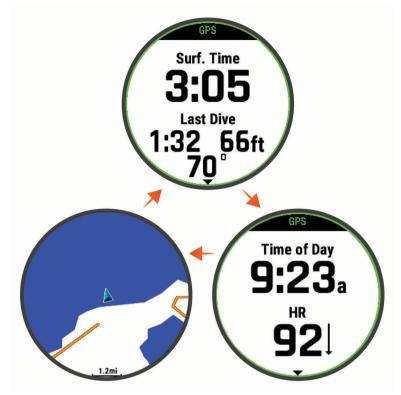
**Pantalla de intervalo de superficie**: muestra el tiempo de intervalo en superficie actual, así como el tiempo transcurrido, la profundidad máxima y la temperatura de la última inmersión en apnea.
