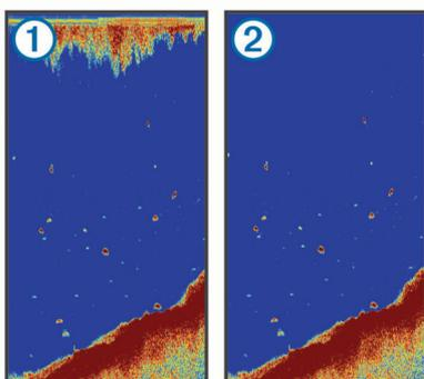
El ruido de superficie ① se crea por la interferencia entre el transductor y el agua. Puedes ocultar el ruido de superficie ② para reducir la saturación. Los anchos de haz más amplios (frecuencias más bajas) pueden mostrar más
