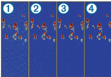
Al cambiar la configuración de interferencia de desactivada ① a baja ②, media ③ y alta ④, el ruido se elimina gradualmente, pero el efecto es mínimo en los retornos intensos del objetivo. Para eliminar la interferencia de la pantalla, deberías utilizar la configuración de interferencias más baja mediante la que se consiga el resultado deseado. Corregir los problemas de instalación que provoquen ruido es la mejor manera de eliminar interferencias.
