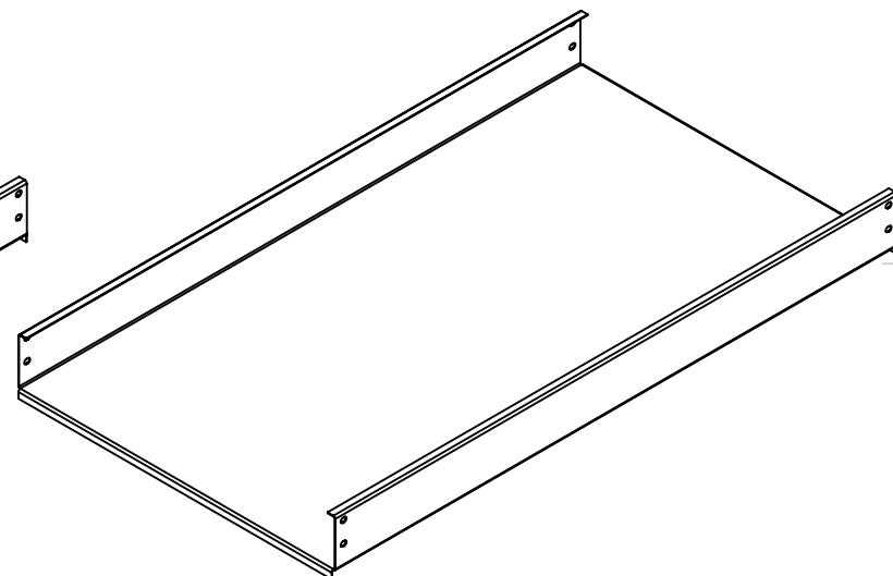
1. Fabricado en lámina de acero SAE 1008 calibre 18.
