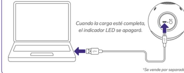
Cuando la carga esté completa, el indicador LED se apagará.
