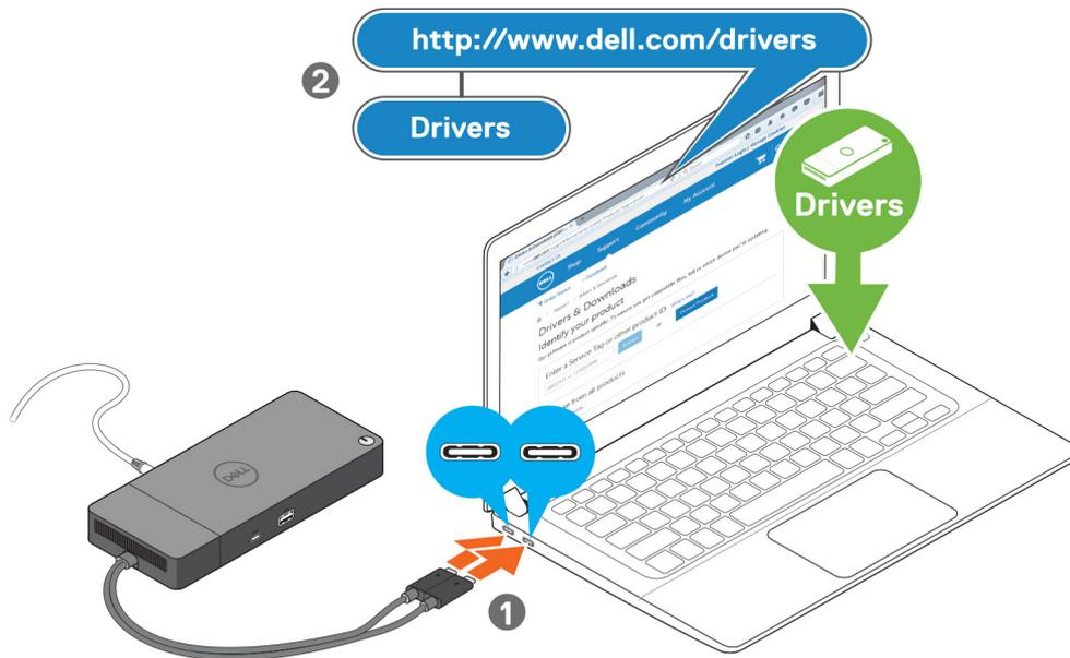
**Ilustración 7. Conexión del conector USB Type-C doble**
