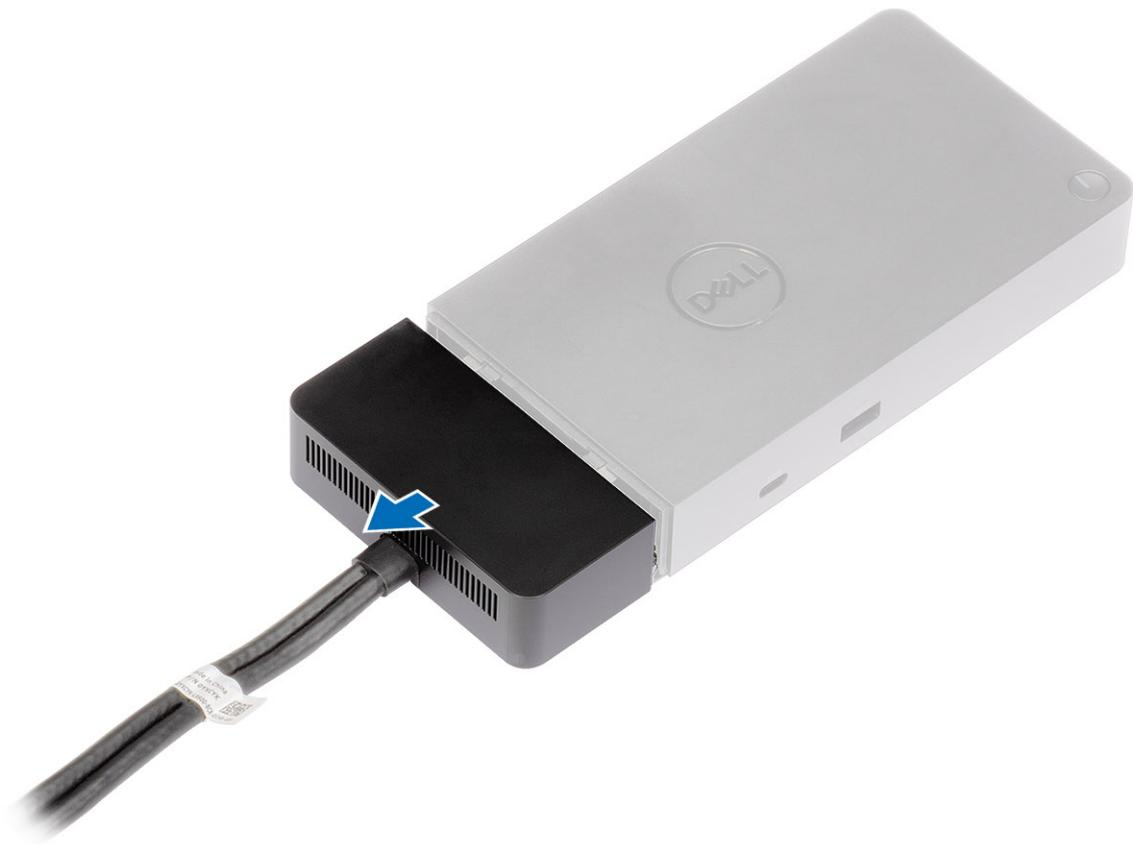
4. Levante y quite el módulo del cable USB Type-C del conector dentro de la estación de acoplamiento.
