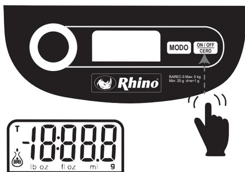
3. Espere hasta que la balanza se coloque en cero y la unidad de medida asignada.
