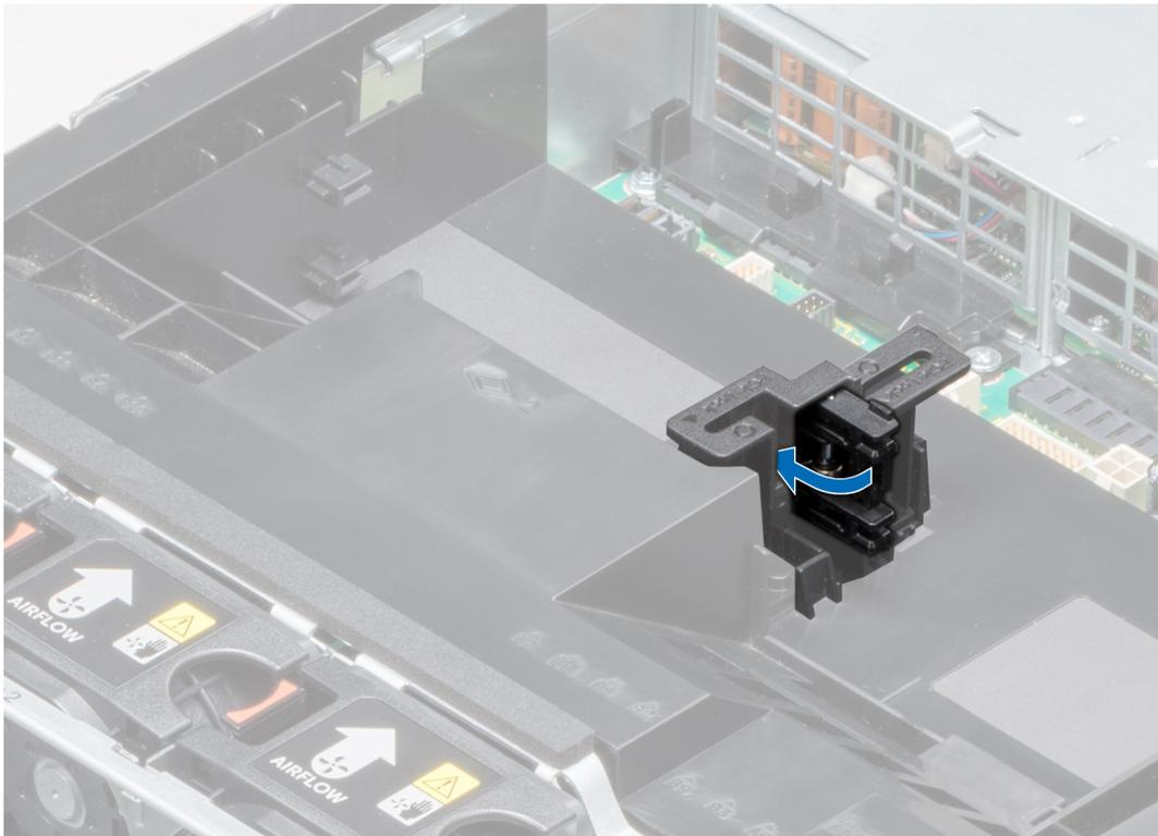
**Ilustración 65. Cierre del pestillo del soporte de tarjeta PCIe**
