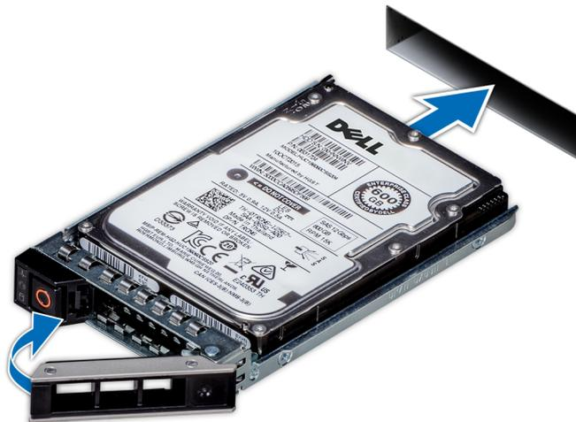
Ilustración 48. Instalación de un portaunidades
