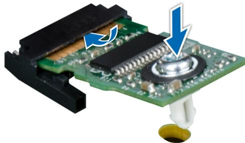
Ilustración 136. Instalación del TPM
