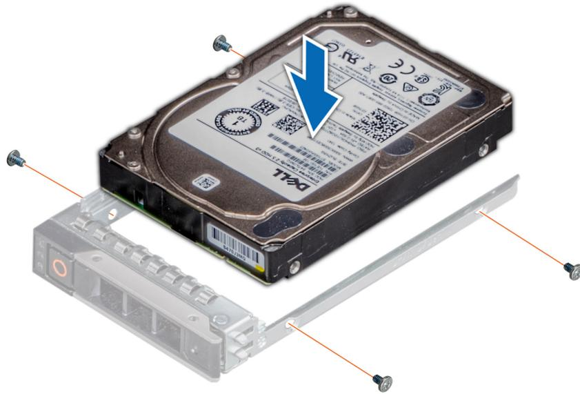
**Ilustración 54. Instalación de una unidad en el portaunidades**
