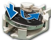
Ilustración 121. Instalación de la batería del sistema
