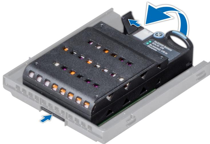
**Ilustración 43. Extracción de la batería NVDIMM-N del soporte**
