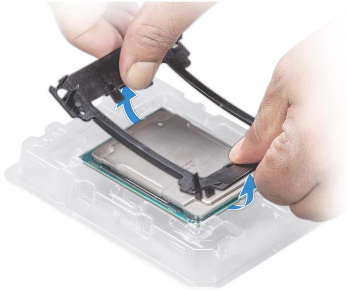
**Ilustración 59. Extracción del soporte del procesador**
