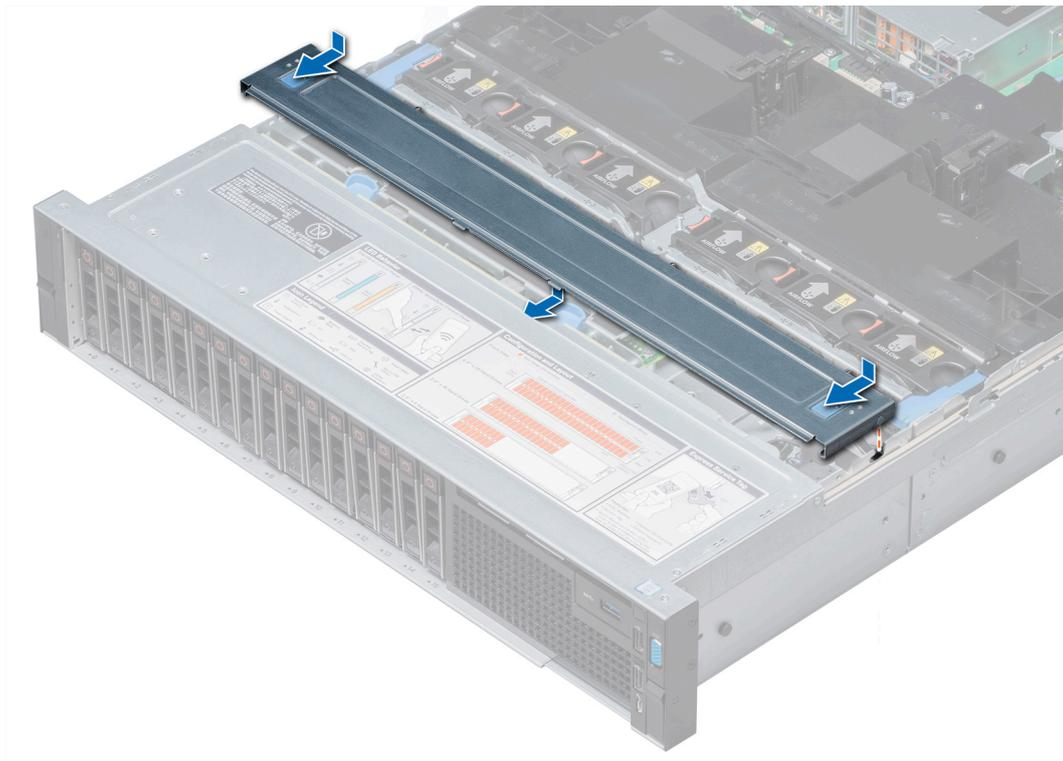
**Ilustración 28. Instalación de la cubierta del plano posterior**
