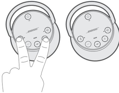
4. Suelte los botones cuando oiga "Presionar los botones *Bluetooth* y disminuir volumen simultáneamente en un segundo dispositivo Bose".
