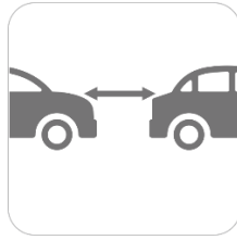
HMW (Headway Monitoring Warning) Advertencia de monitoreo de avance
