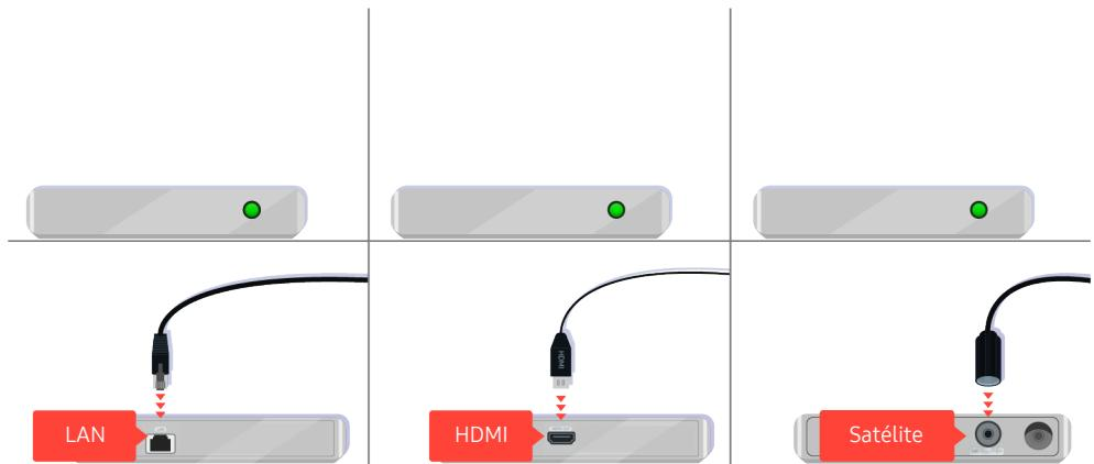
Si utiliza un decodificador, verifique la conexión del cable. El cable por verificar depende del tipo de decodificador.
