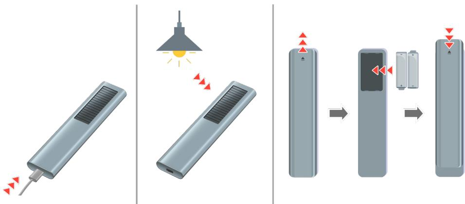
Si no puede ver las señales de infrarrojos, cargue el control remoto usando el puerto USB (tipo C) en la parte inferior o dé vuelta el control remoto para exponer la celda solar. Si el control remoto tiene baterías, reemplácelas por unas nuevas.
