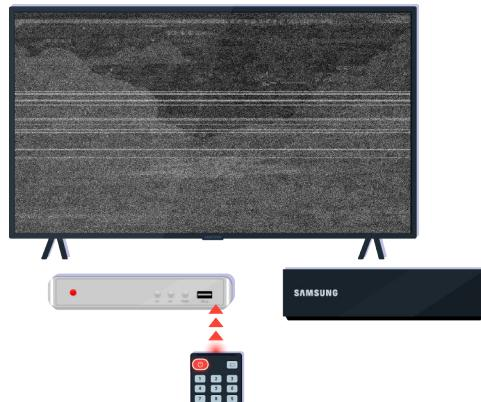
Si utiliza un control remoto multimarca o uno universal y este no puede operar un dispositivo externo, acerque este último a la caja de One Connect.
