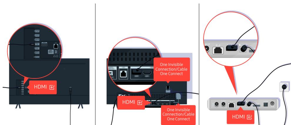
Verifique la conexión del cable HDMI al televisor o la caja de One Connect.
