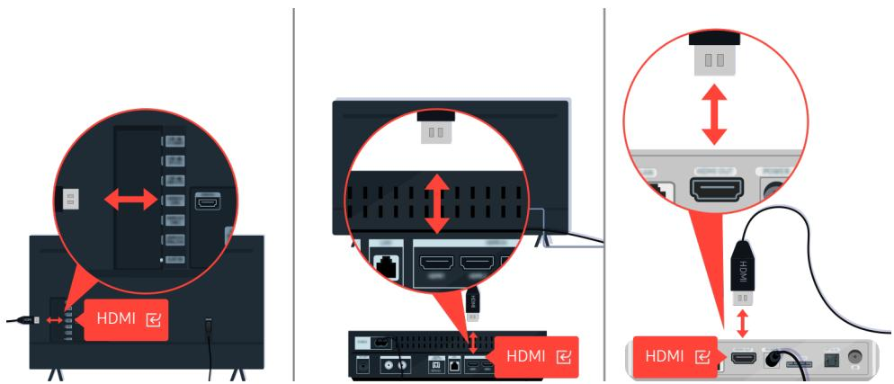
Primero, desconecte los cables de alimentación y los cables HDMI en la parte posterior del televisor y la caja de One Connect y vuelva a conectarlos; luego, desenchufe el cable de alimentación y vuelva a enchufarlo en la toma de pared.
