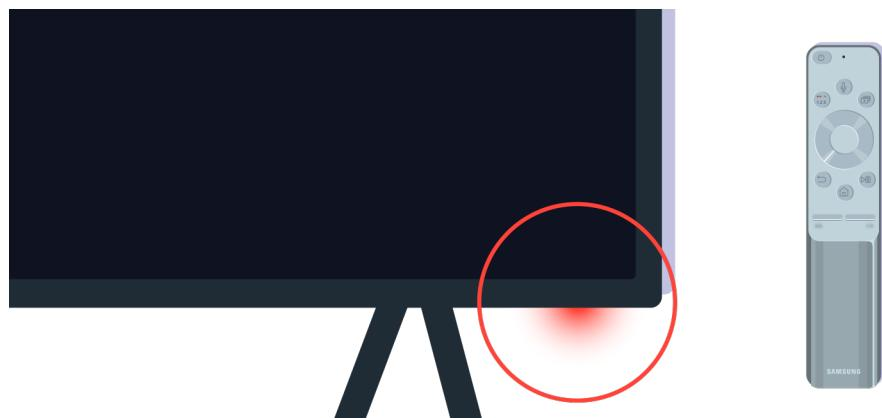
Vuelva a verificar el sensor del control remoto. Si el LED está encendido, presione el botón de encendido del control remoto para encender su televisor.
