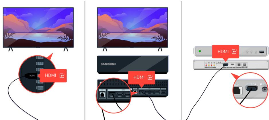
Si el problema continúa, intente conectar otro dispositivo externo al televisor con un cable HDMI. Si la pantalla se ve bien, es posible que su dispositivo externo esté fallando.
