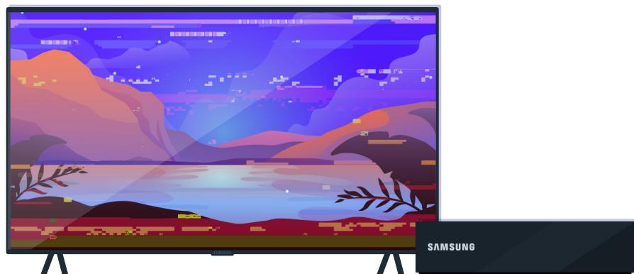
Verifique la antena y las conexiones de cables de entrada.
