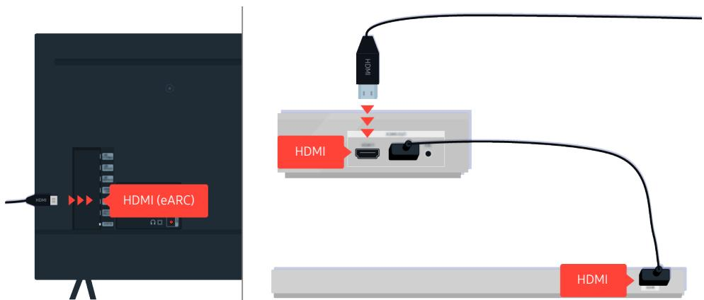
Si la barra de sonido está conectada a un receptor, y el receptor está conectado al televisor con un cable HDMI, verifique el conector HDMI en la parte posterior del televisor. El cable debe estar conectado al puerto HDMI (eARC) de su televisor.
