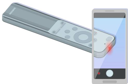
Puede verificar si se transmite la señal presionando el botón de encendido y observando la punta delantera del control remoto a través de la cámara de su teléfono inteligente.
