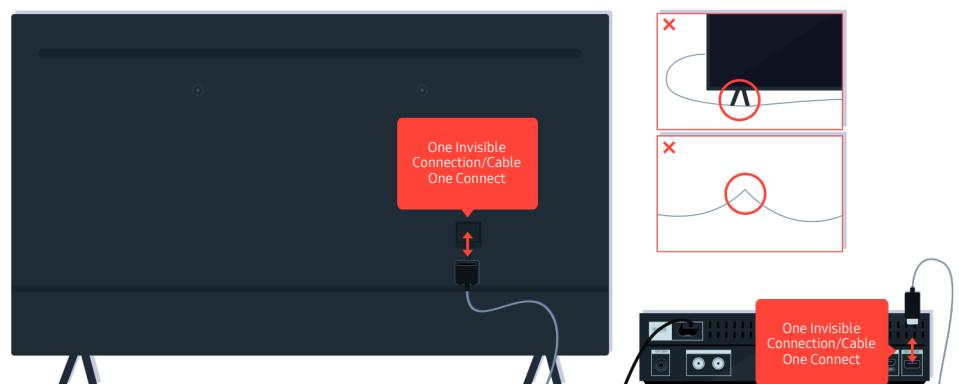
Desconecte y vuelva a conectar One Invisible Connection o Cable One Connect entre el televisor y la caja de One Connect. Asegúrese de que One Invisible Connection o Cable One Connect no esté demasiado apretado o retorcido.
