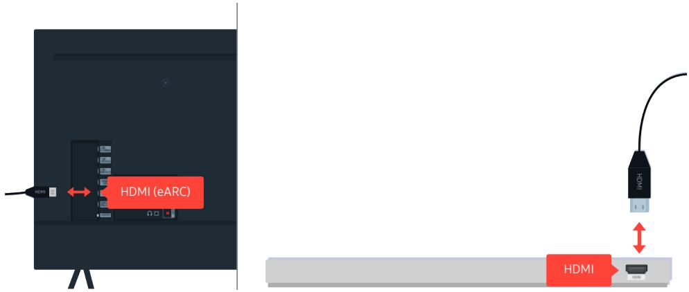
Si la barra de sonido no emite sonido, y si está conectada al televisor con un cable HDMI, verifique el conector HDMI (eARC) en la parte posterior del televisor.
