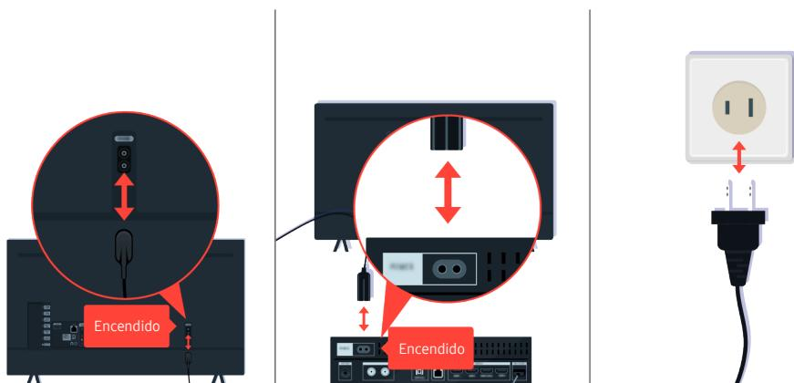
Primero, desconecte los cables de alimentación y los cables HDMI en la parte posterior del televisor y la caja de One Connect y vuelva a conectarlos; luego, desenchufe el cable de alimentación y vuelva a enchufarlo en la toma de pared.
