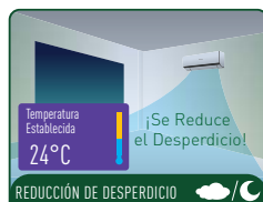
La temperatura establecida permanece sin cambios. ECONAVI reduce la potencia de enfriamiento en una cantidad equivalente, para incrementar la temperatura en 1 grado Celsius.
