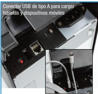
Conector USB de tipo A para cargar tabletas y dispositivos móviles
