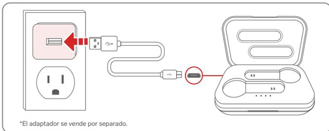
Durante el proceso de carga, los LED indicadores destellarán 1 a 1. Cuando el proceso finalice, los LED indicadores permanecerán encendidos.
