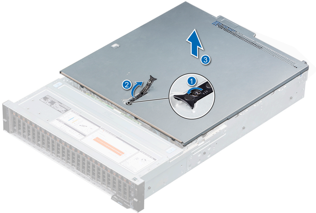
Ilustración 19. Extracción de la cubierta del sistema
