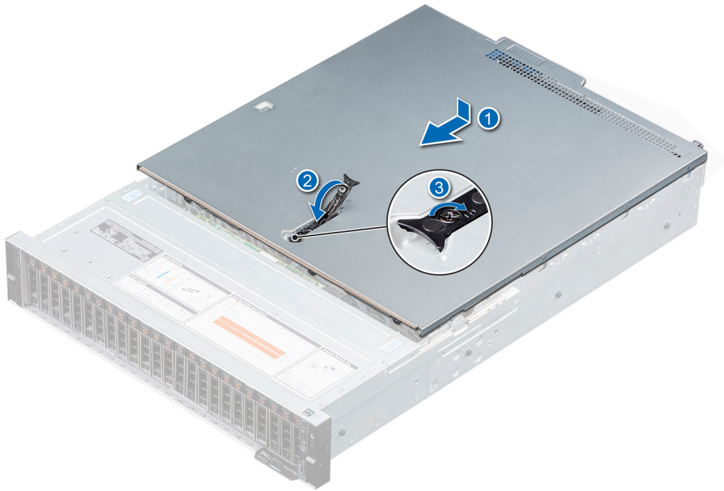
Ilustración 20. Instalación de la cubierta del sistema
