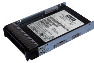
Lenovo 4XB7A72438. SSD, capacidad: 480 GB, Factor de formato SSD: 2.5", Velocidad de lectura: 560 MB/s, Velocidad de escritura: 530 MB/s, Componente para: Servidor/estación de trabajo
