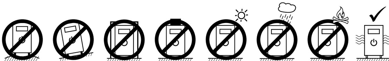
Fig. 4-1 Avisos de instalación
