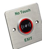
Hikvision Digital Technology DS-K7P03/T. Tipo de alimentación: CC, Rango de voltaje DC: 12 V, Consumo de energía: 70 mA. Material de la cubierta: Acero inoxidable. Ancho: 86 mm, Profundidad: 86 mm, Altura: 25.7 mm
