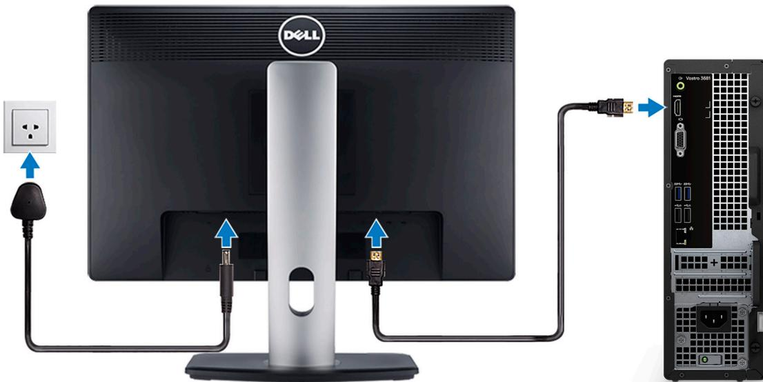
**NOTA:** Si solicitó la computadora con una tarjeta gráfica discreta. Conecte el cable de pantalla a los conectores de la tarjeta gráfica discreta.
