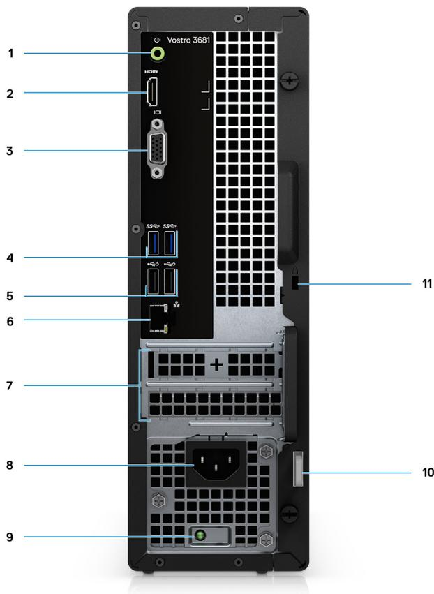
1. ● Conector de audio de línea de salida y nueva gestión de tareas a línea de entrada (para computadoras con configuración de Realtek)
