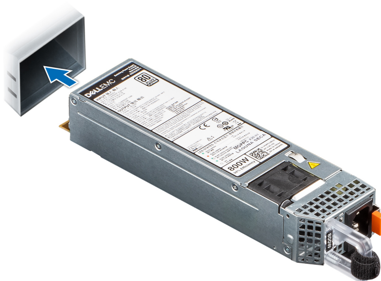
Ilustración 80. Instalación de una fuente de alimentación
