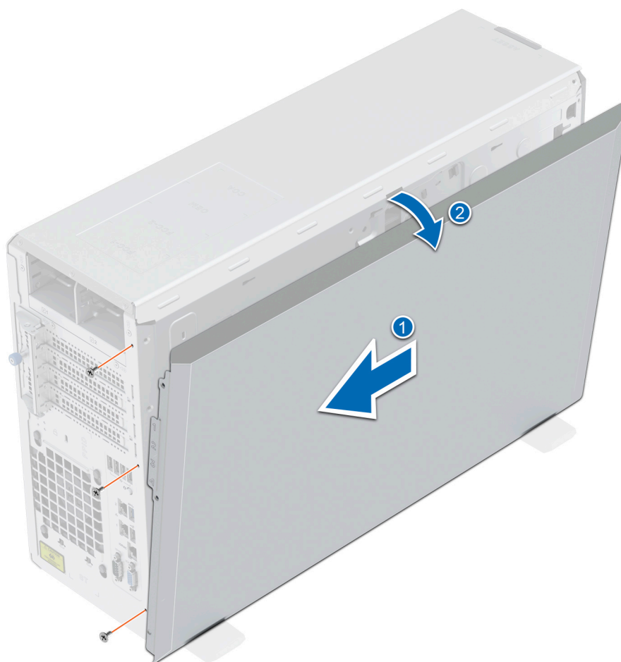
Ilustración 94. Extracción de la cubierta lateral del sistema
