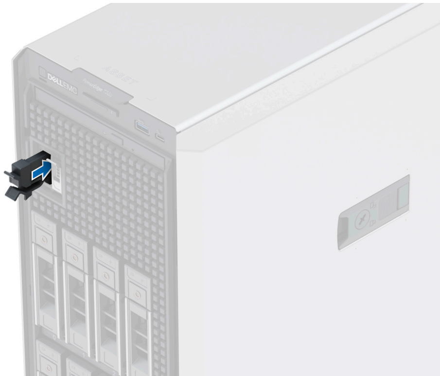
Ilustración 62. Instalación del soporte de tarjetas de relleno de Boot Optimized Storage Subsystem S2
