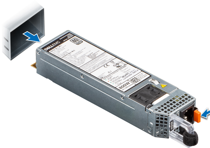
Ilustración 79. Extracción de una fuente de alimentación
