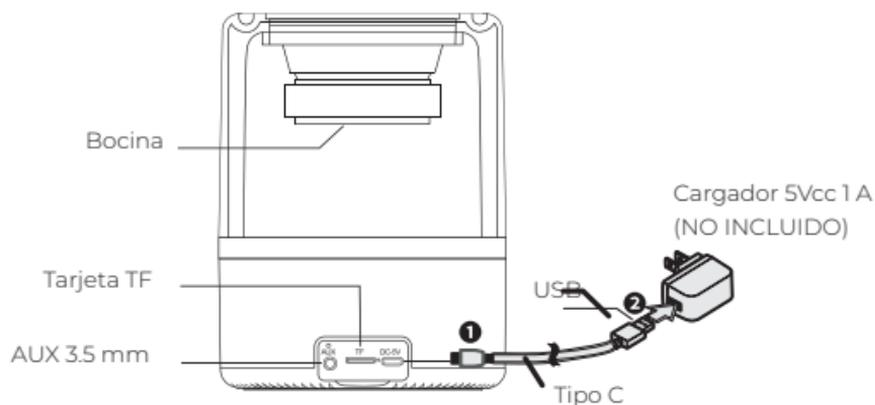
\* Conecte el cable tipo C a la bocina y el otro extremo a un adoptador de corriente o puerto de carga ( 5 Vcc 1 A)
