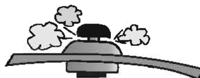
Figura 6. Válvula de seguridad dejando salir el vapor
